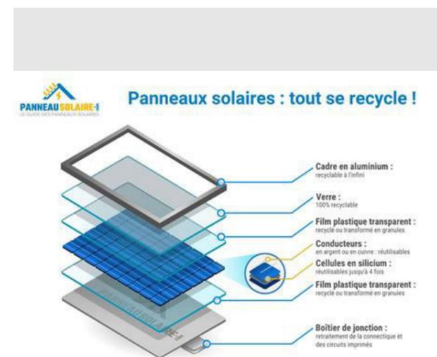
Figure 52 : Les modalités de recyclage des panneaux solaires
